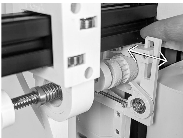
10.3.8 Pour ce faire, vous pouvez déplacer le mécanisme d'avant en arrière et/ou tourner légèrement la tige filetée.
