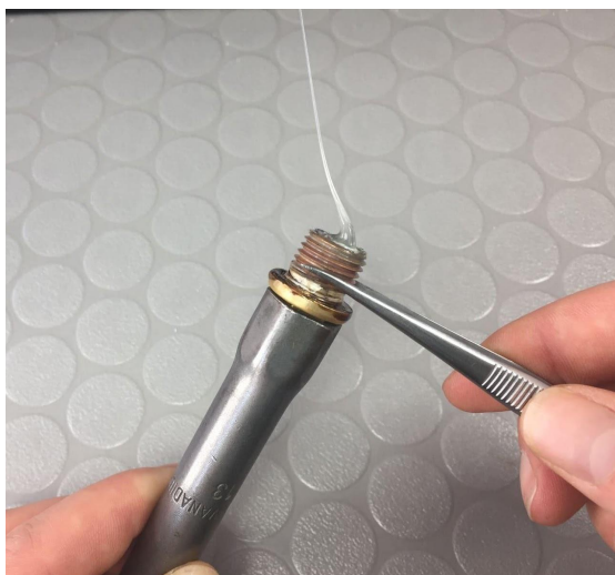
13.1.2 Retirer la buse de la clé à douille à l'aide d'une pince à épiler.
