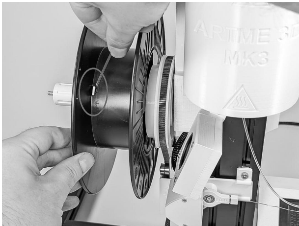
10.3.2 Het filament wordt vervolgens in de opening aan de onderkant van de spoel geregen. Draai hiervoor de lege spoel met de hand in een positie waarin u de opening kunt zien. Duw de draad erdoor.
