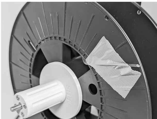
10.3.3 Het filament wordt omgebogen aan de buitenkant van de spoel en vastgezet met plakband. Met een beetje oefening en goed gedroogd materiaal kun je dit ook zonder plakband doen door het filament te buigen. Zorg ervoor dat het filament redelijk strak blijft. Het uitstekende uiteinde van het filament moet worden afgesneden.
