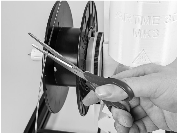
10.3.1 Knip het filament boven de spoel af.
