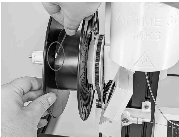
10.3.2 Żyłka jest następnie przewlekana przez otwór w dolnej części szpuli. W tym celu należy ręcznie obrócić pustą szpulę do pozycji, w której widoczny jest otwór. Przełóż przez niego filament.
