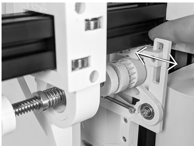
10.3.8 Selleks võite mehhanismi edasi-tagasi liigutada ja/või keermestatud spindlit veidi keerata.
