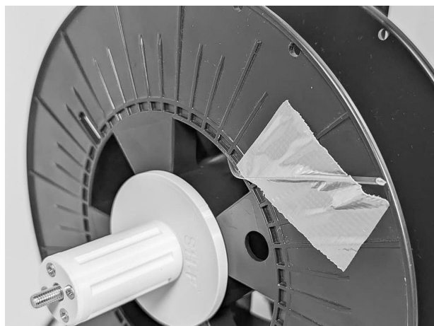
10.3.3 Lõng painutatakse ümber pooli välisküljele ja kinnitatakse kleeplindiga. Väikese harjutuse ja hästi kuivatatud materjali korral saab seda teha ka ilma kleeplindita, painutades filamenti. Jälgige, et filament jääks mõistlikult pingule. Filamendi väljaulatuv ots tuleks ära lõigata.
