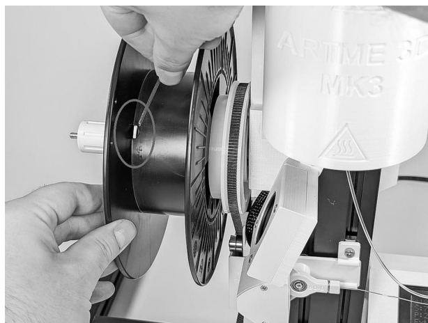
10.3.2 Seejärel keermestatakse niit pooli põhjas asuvasse avasse. Selleks pöörake tühja pooli käsitsi sellisesse asendisse, kus avad on nähtavad. Lükake niit sellest läbi.
