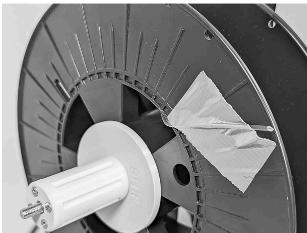
10.3.3 Filamentet bøjes om på ydersiden af spolen og fastgøres med tape. Med lidt øvelse og godt tørret materiale kan du også gøre dette uden tape ved at bøje filamentet. Sørg for, at filamentet forbliver rimeligt stramt. Den fremspringende ende af filamentet skal klippes af.
