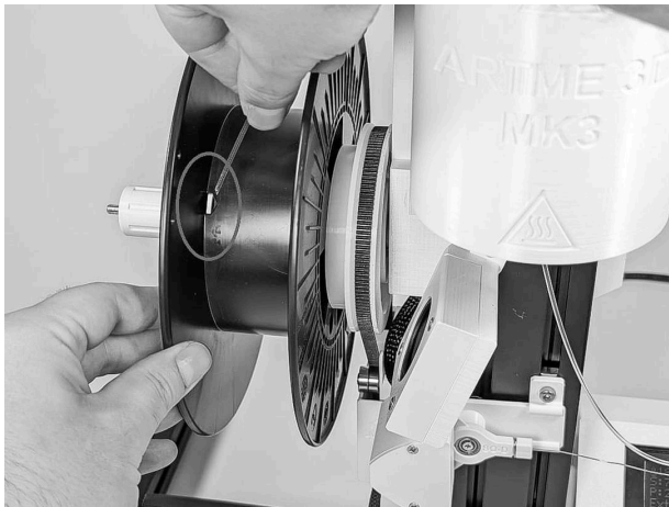
10.3.2 Filamentet trækkes derefter ind i åbningen i bunden af spolen. Det gør du ved at dreje den tomme spole med hånden, så du kan se åbningen. Skub filamentet gennem den.
