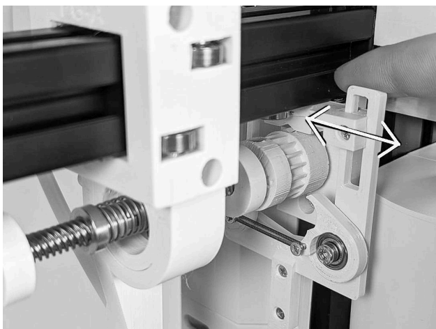
10.3.8 For at gøre dette kan du bevæge mekanismen frem og tilbage og/eller dreje gevindspindlen en smule.
