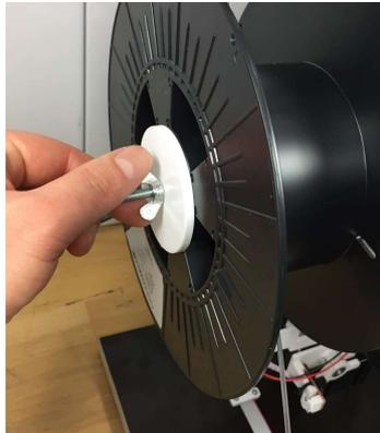
2. Schneiden Sie das Filament oberhalb der Spule ab. Der Filamentanfang wird in die Öffnung am Boden der Spule eingefädelt. Drehen Sie dazu die leere Spule mit der Hand in eine Position, in der Sie die Öffnung sehen können. Schieben Sie das Filament hindurch.
