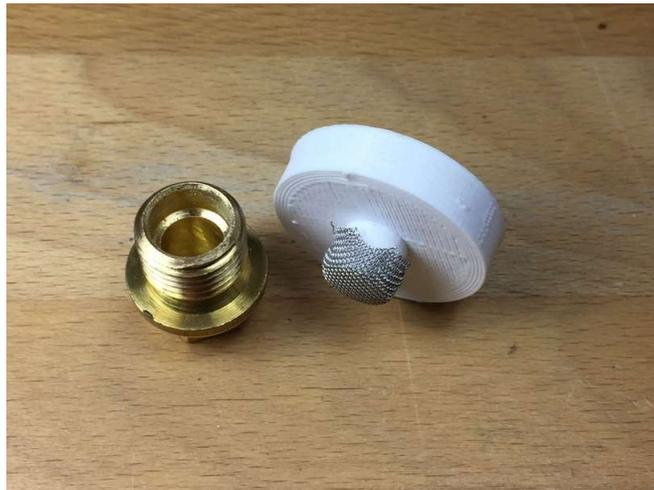
5. Wenn des Drahtgewebe auf der Biegehilfe stecken bleibt, nehmen Sie dieses ab und drücken es erneut in die Düsenöffnung.
