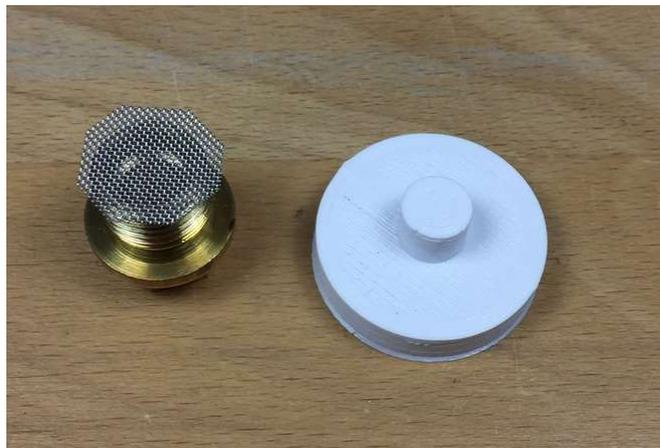
3. Drücken Sie die Biegehilfe mittig in das Drahtgewebe, sodass dieses in die Öffnung gepresst wird. Sie können im Zweifel einen Schraubstock zu Hilfe nehmen.
