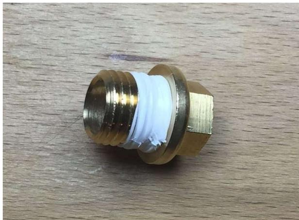
3. Auch die kleine Düse kann auf die gleiche Weise abgedichtet werden. Die kleine Düse ist eine Standard V6 (E3D Style) 3D Drucker Düse, welche günstig im Internet nachgekauft und aufgebohrt werden kann.
