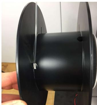
3. Der Filamentanfang wird außen an der Spule umgebogen und mit einem Klebestreifen befestigt. Drehen Sie dann direkt die Flügelschraube wieder fest, sodass die Spule vom Spulenmotor gedreht wird. Sie muss recht fest gedreht werden, dass sie sich im Betrieb nicht öffnet.
