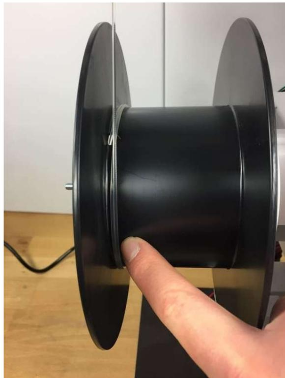
6. Es kann passieren, dass einer oder beide Zacken-Mitnehmer an der Schwinge nach unten verdreht werden.
