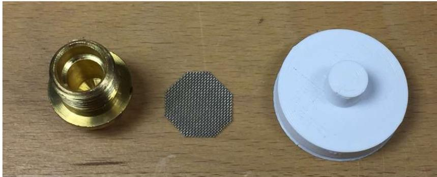
2. Legen Sie das Drahtgewebe auf die Düsenöffnung. Achten Sie darauf, dass es mittig liegt.
