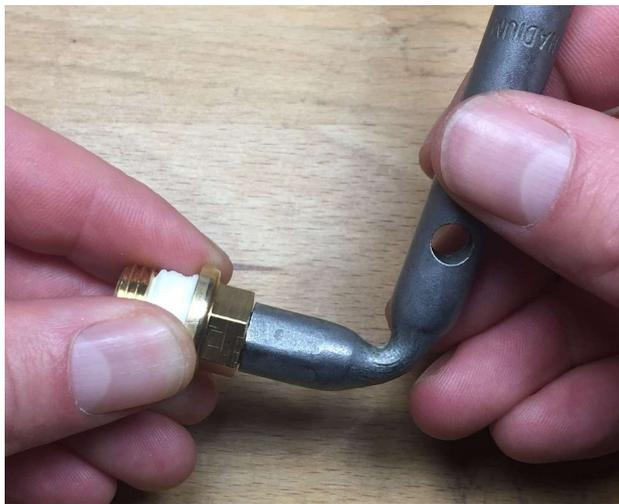
5. Die Düse wird nun wieder in das Rohr geschraubt. Das Rohr sollte heiß sein, sodass Rest-Kunststoff im Gewinde des Rohres weich ist. Das funktioniert am einfachsten mit einem Steckschlüssel.
